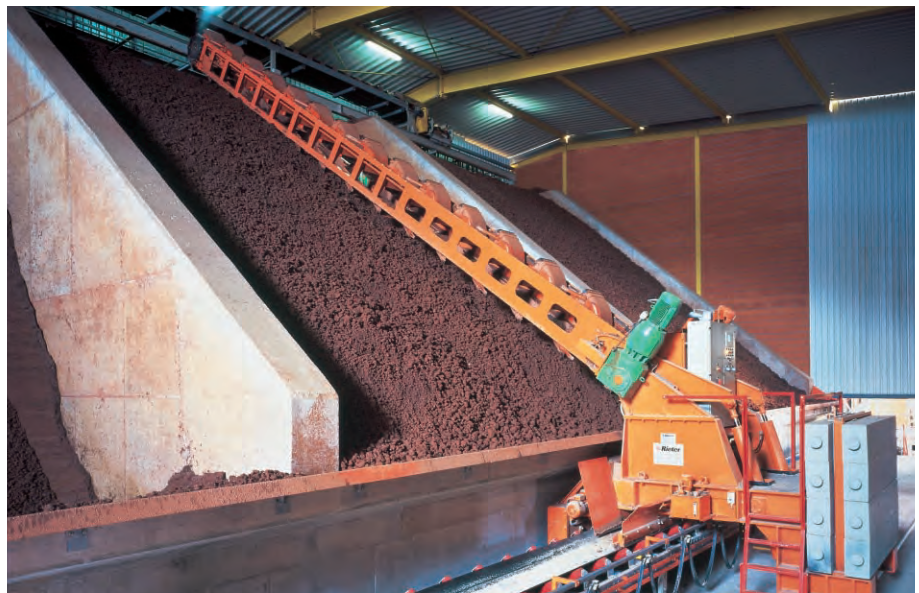
Bild 26 Homogenisierung des Tons im Sumpfhaus.
