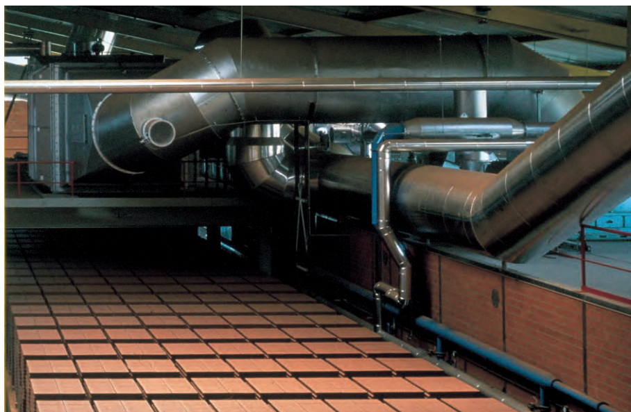
Bild 28 Abwärme aus dem Tunnelofen wird über Kraft-Wärme-Kopplung zum Betrieb der Ventilatoren des Trockners genutzt.
