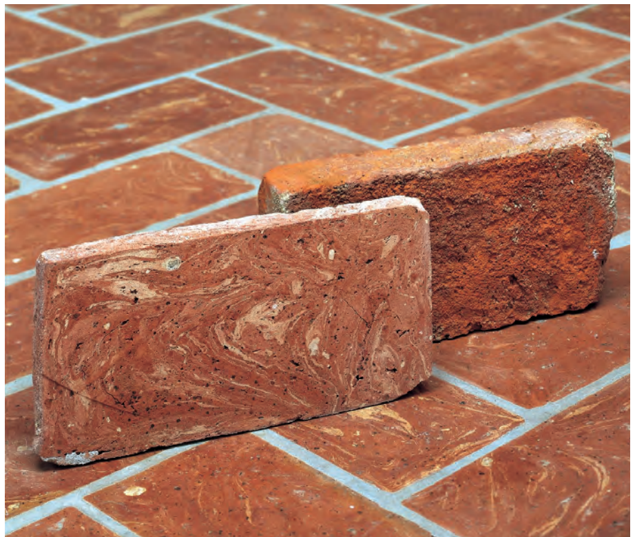
Bild 15 Wiederverwertung von Abbruch-Ziegeln als hochwertiger Bodenbelag.
