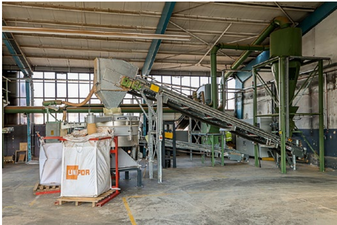
Ressourcenschonendes Ziegelrecycling: In sogenannten BigBags können Kunden Verschnitt und Ziegelbruch an unsere Werke zurückgeben. Die Trennanlage sorgt dann für die Aufbereitung der Reste und ermöglicht eine Rückführung in den Produktkreislauf.
