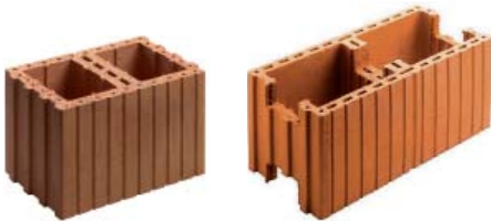
Schallschutz-Füllziegel (links) und Schalungsziegel (rechts) zum Verfüllen mit fließfähigem Beton C12/15 (0-16, F4/5) für Wohnungstrennwände mit Wanddicken 17,5/24/30 cm, R_w \approx 62 dB (24/30 cm)
