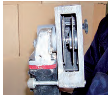
Spezial-Schlitzfräse mit 2 Diamant-Trennscheiben und verstellbarer Schnittbreite und -tiefe.
