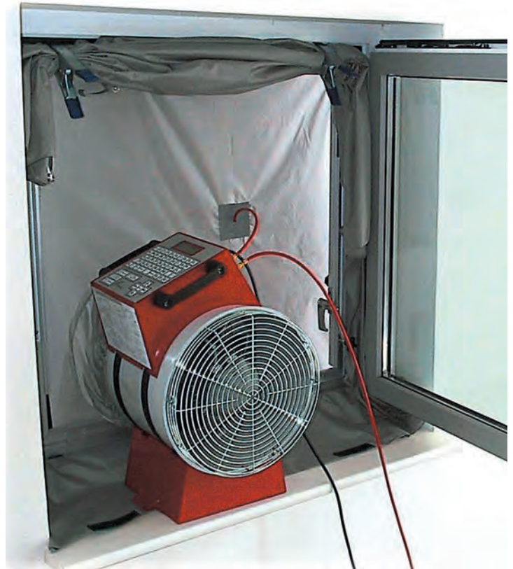
Das Blowtest-Messgerät wird für den Zeitraum der Messung in ein Fenster oder eine Türe eingebaut
