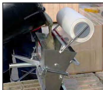
Das Glasvlies soll an der Unterkante ca. 20 cm vorlaufen. Dann den Vorratsbehälter beidseitig des Glasvlies-Führungskanals befüllen und die Auslaufdicke mittels Verstellerschraube auf 2,0 mm einstellen.
