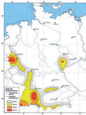
Bild: Erdbebenzonierungskarte für die DIN 4149 in der Fassung von 2005 [1, 2] auf der Grundlage der Einschätzung der Erdbebengefährdung der Bundesrepublik Deutschland [3, 4] mit freundlicher Genehmigung von Dr. G. Grünthal, Geoforschungszentrum Potsdam, Section 5.3 Engineering Seismology, Telegrafenberg, 14473 Potsdam.
